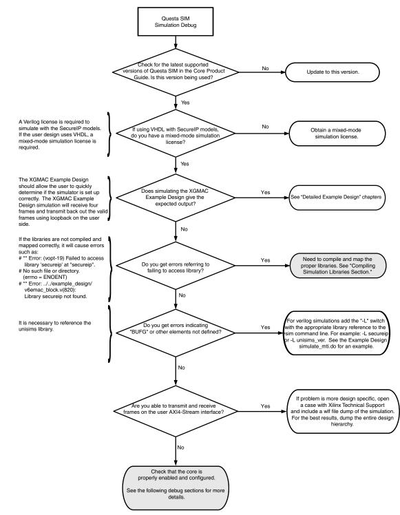
Figure C-1: Questa SIM Debug Flow Diagram
